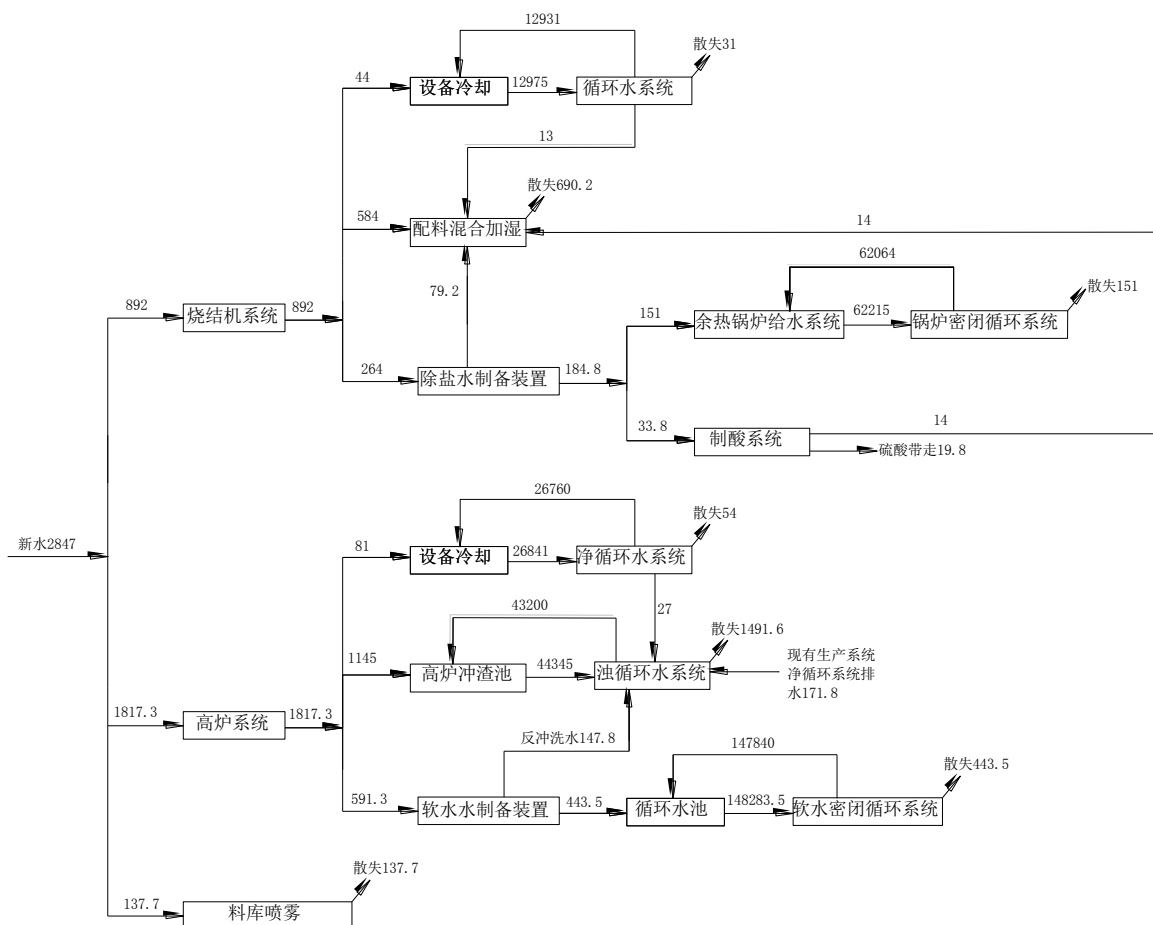
图 4-9 改建工程水平衡图 单位 m 3 /d
